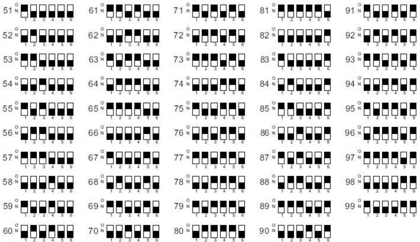
Correspondance entre n° de décodeur et position associée des switch
