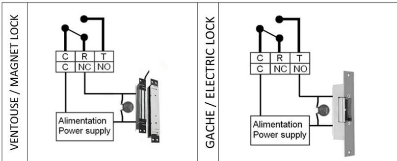
⚠ La tension d'alimentation de la ventouse ou de la gâche électrique doit être inférieure à 42v alternatif ou à 60v continu. Si celle-ci est supérieure à ces valeurs, utiliser un relais intermédiaire.
