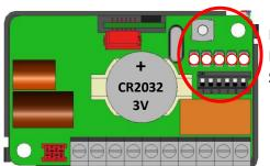
BP Leds d'état 1 à 5 Switch 1 à 6
