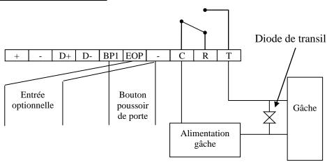
Au repos, la gâche maintient mécaniquement la porte verrouillée. Lorsque le relais est actionné par la centrale, le courant passe et la gâche libère la porte (appui sur le bouton poussoir ou passage d'un badge autorisé).
