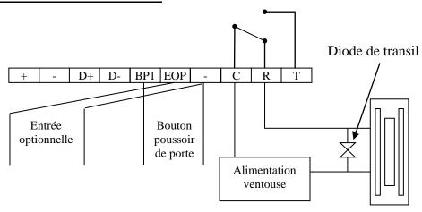
Au repos, la ventouse est alimentée et la porte est verrouillée. Lorsque le relais est actionné par la centrale, la ventouse libère la porte (appui sur bouton poussoir ou passage d'un badge autorisé).
